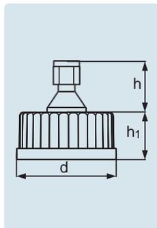
Le support pour thermocouple pour le capuchon à visser DURAN® GL 45 est composé d'un support solidement intégré dans un capuchon à visser GL 45 bleu en polypropylène. Celui-ci contient jusqu'à trois fils séparés pour thermocouple. La tubulure en PTFE du support pour thermocouple assure une mesure de la température à la pointe de la sonde thermique et son maintien en position dans le flacon pendant tout le cycle de stérilisation.
